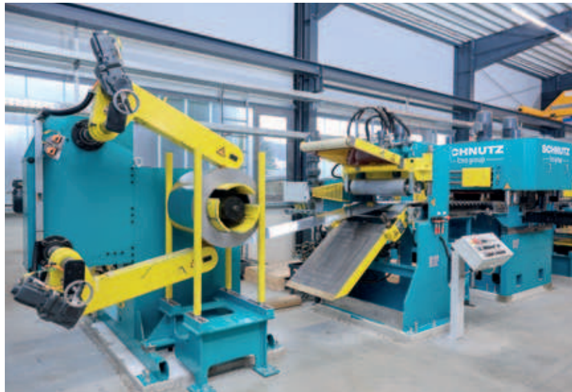
Einzugstreiber mit Abwickler Entry pinch roll unit with decoiler
