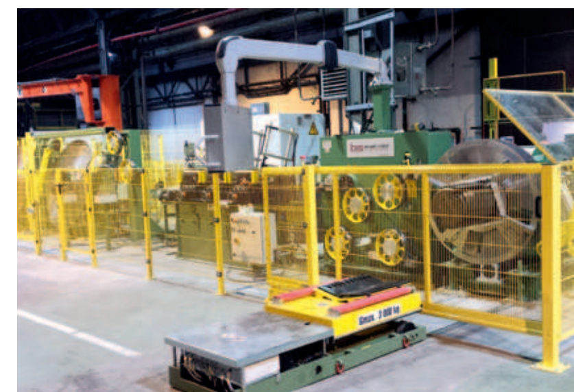
Verlegespuler mit Doppelabwickler Traverse winder with double decoiler:
