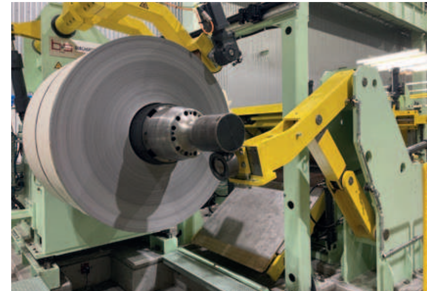
Abwickler und Dornabstützung Decoiler and outboard bearing
