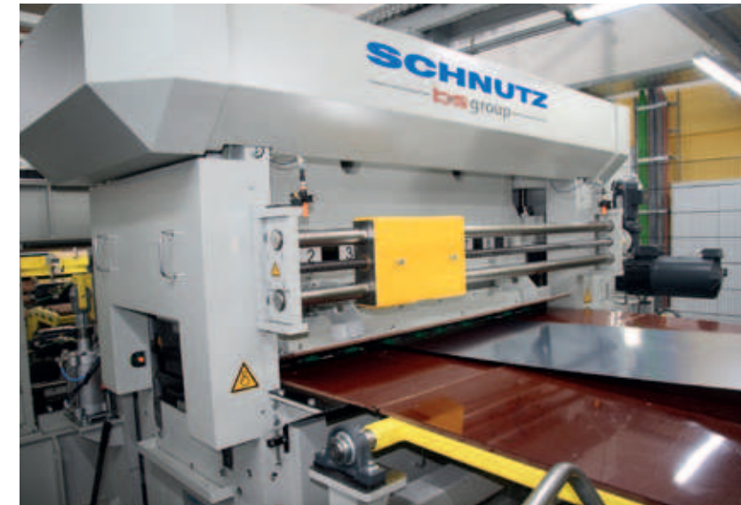
Multi-Blanking-Anlage für Edelstahl Multi-Blanking-Line for Stainless Steel:
