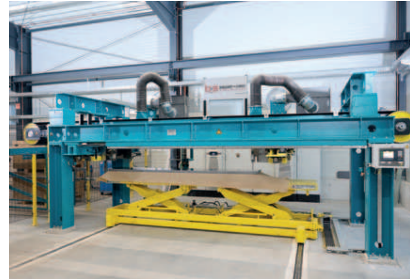
Vakuumstapler mit ausfahrbaren Stapelsentisch Vacuum stacker with moveable stacking table
