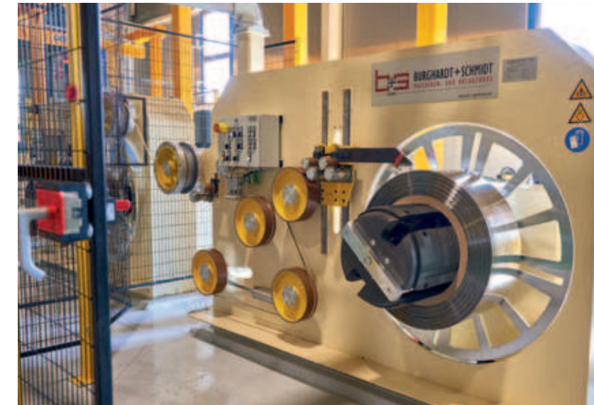
Verlegeaufwickler mit Tänzeinheit und Verlegefinger Traverse winder with dancer and strip guiding finger
