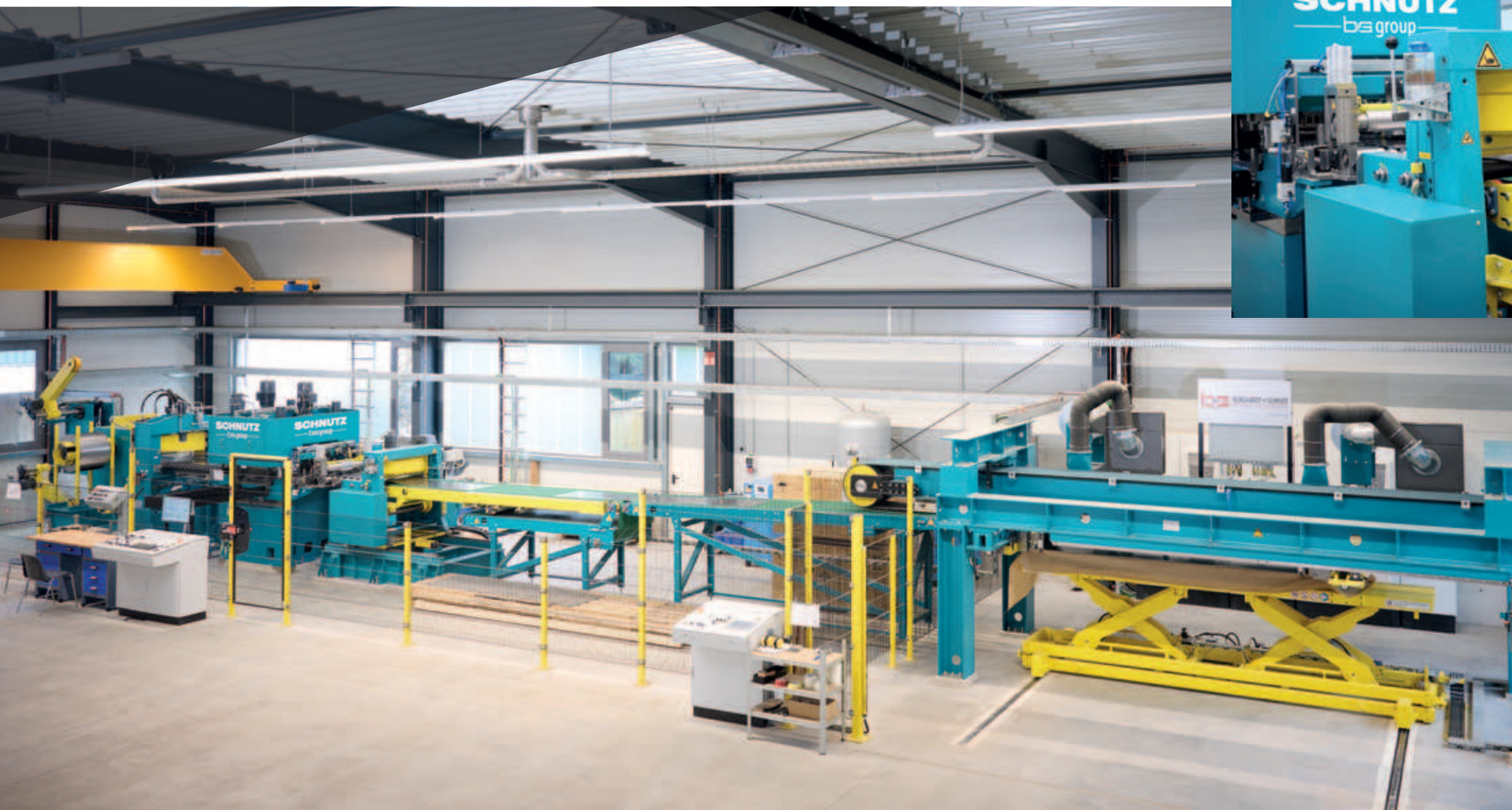
Querteilanlage für Edelstahl Cut-to-length line for stainless steel:
