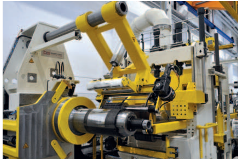
Vollautomatische Wechselsequenz und Haspelkopfklemmung Fully automatic changing sequence and mandrel clamping to the recoiler
