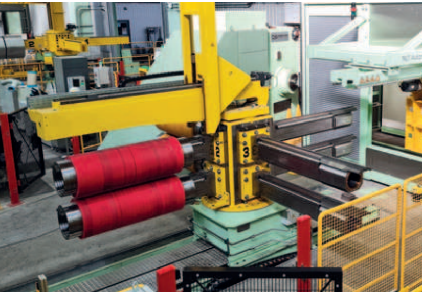
Automatischer vierarmiger Werkzeugwechsler mit Abschiebeschild und Werkzeugroboter Automatic four-arm tool changer with push-off plate and tooling robot
