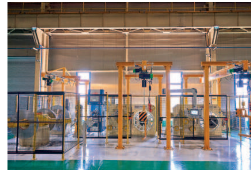
Verlegespulanlage mit zwei Verlege- aufwickler und Laserschweißmaschine Traverse winding line with two traverse winders and laser welder:
