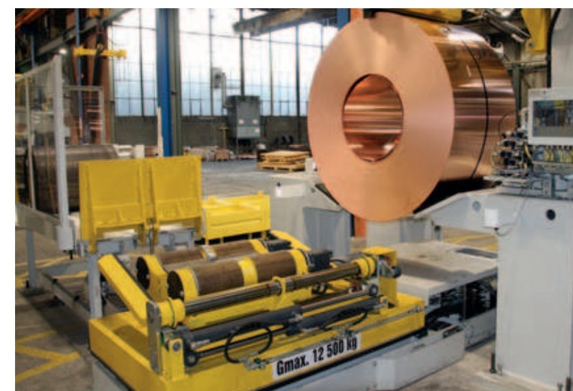
Bundlager mit Andrückvorrichtung, Spulenlager und Bundhubwagen mit Tragrollen sowie hydraulischen Sicherungsarmen Coil storage with hold-down arm, sleeve storage and coil car with support rolls and hydraulic safety arms
