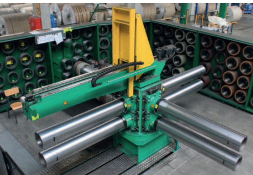
Vierarmiger Automatischer Werkzeugwechsler mit Abschiebeschild Four-arm tool changer with push-off plate
