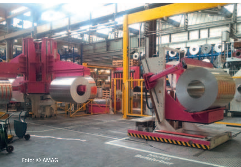
Drehkreuz 4-armig mit Andrückvorrichtung Turnstile 4 arms with pressure device
