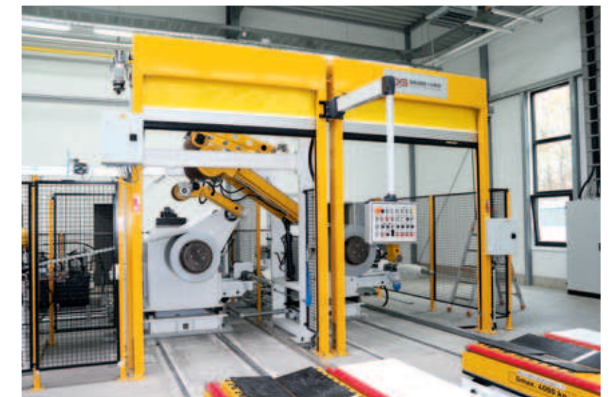
Bandanlage – Einlauf mit 2 Abwickler, Bundhubwagen und Heftmaschine Processing line – entry with 2 decoilers, coil car and stitcher
