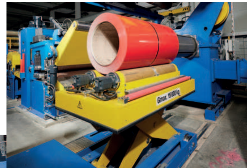
Bundhubwagen mit angetriebenen Tragrollen und integrierter Waage Coil car with with support rolls and integrated scales
