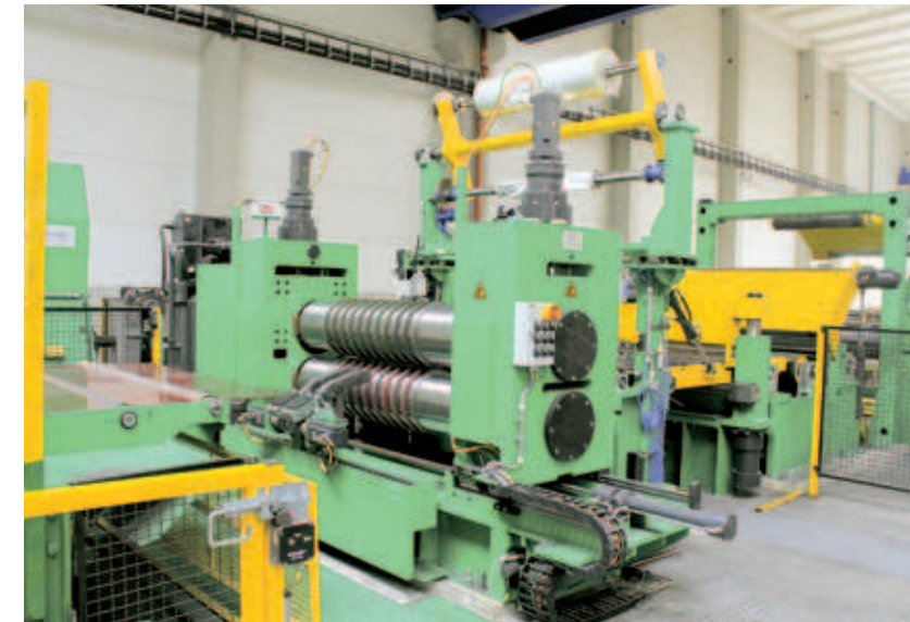
Präzisions-Längsteilschere Twin-CNC- Ausführung High precision slitting shear twin CNC type
