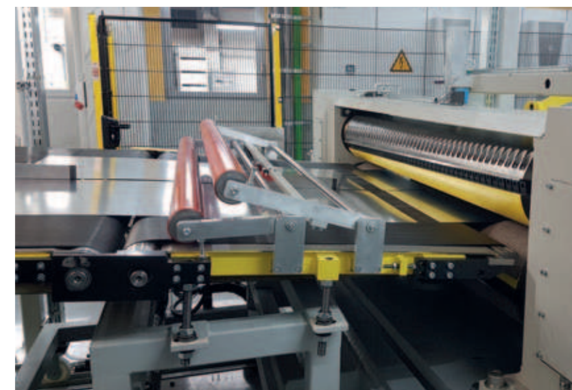
Trommelschere für die Platinen Rotary Drum Shear for the sheets
