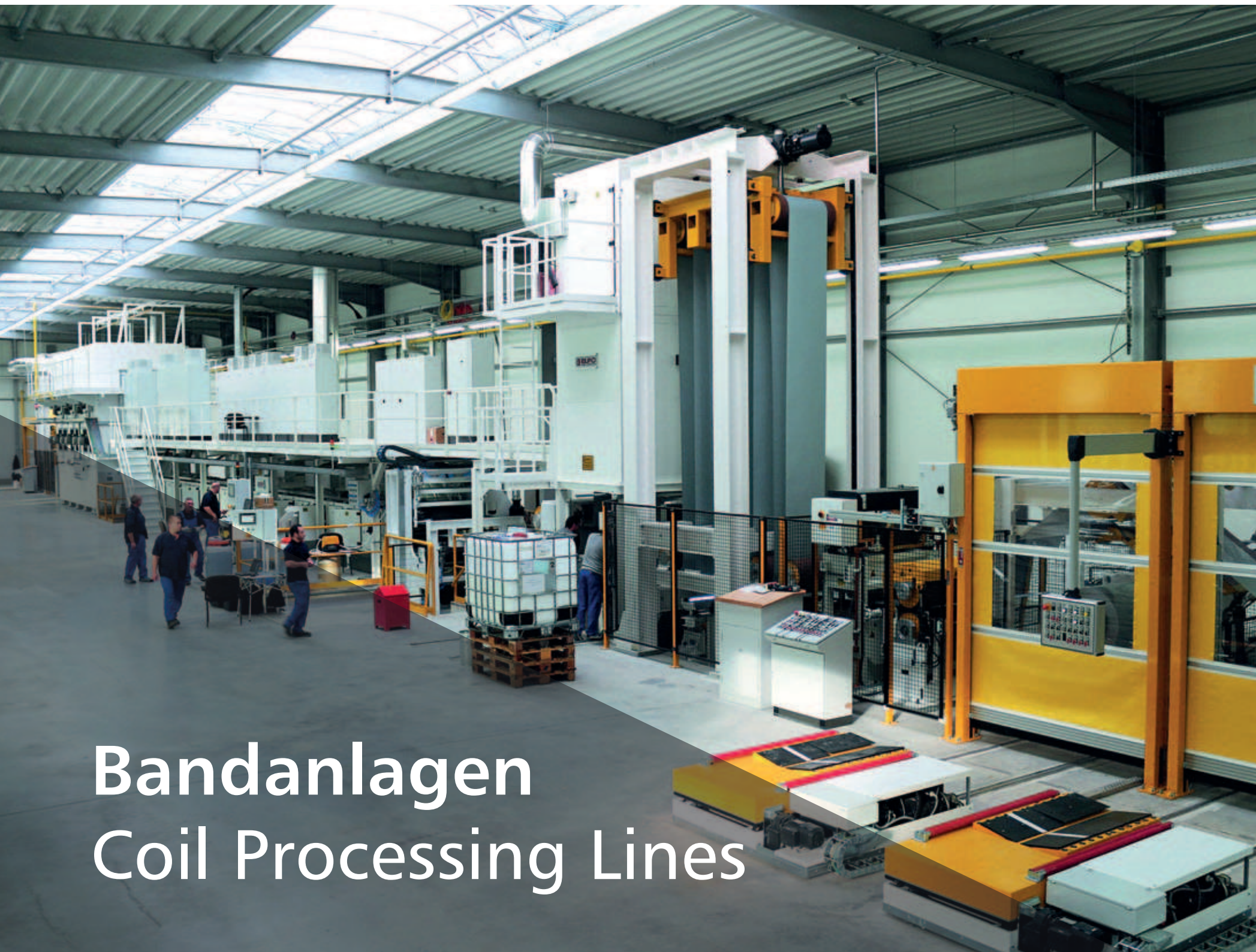
Bandanlage – Einlauf mit 2 Abwickler, Bundhubwagen und Heftmaschine Processing line – entry with 2 decoilers, coil car and stitcher
