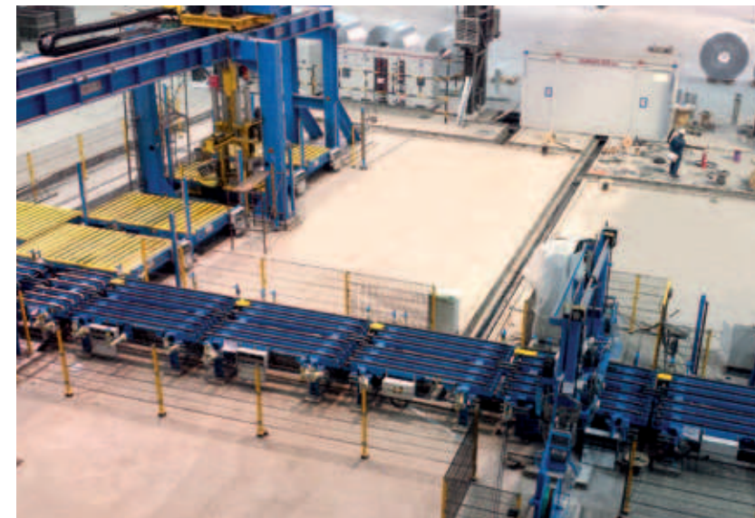
Vollautomatische Verpackungsanlage für Aluminium-Coils Fully automatic packaging line for aluminum coils
