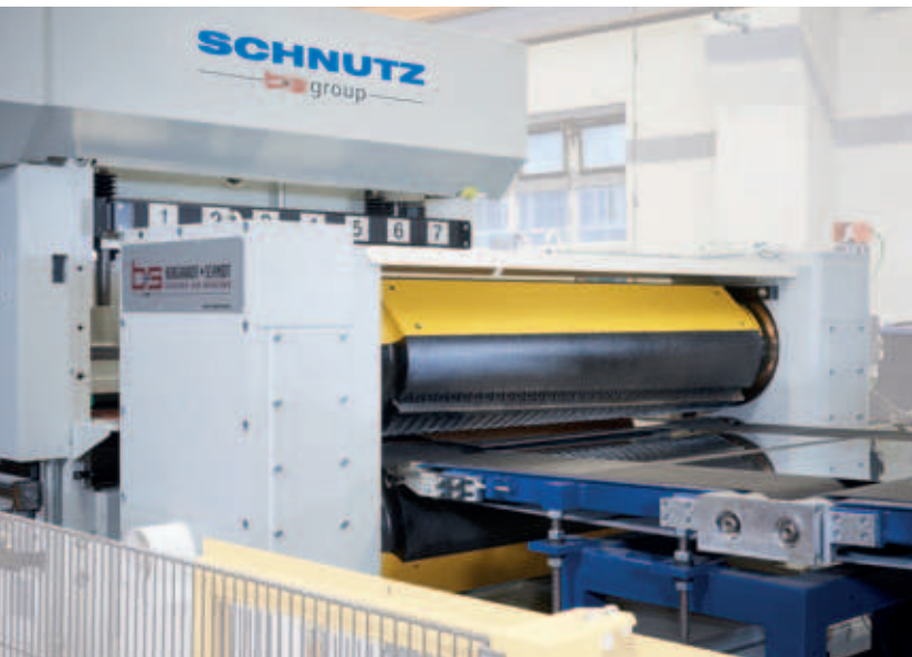
Schnutz Richtmaschine und Trommelschere mit automatischer Schnitthluftverstellung Schnutz leveling machine and rotary drum shear with automatic clearance adjustment
