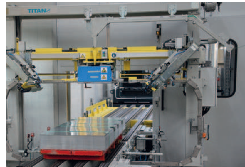
Automatische Abbindemaschine für das gestapelte Packet Automatic strapping machine for the stacked package
