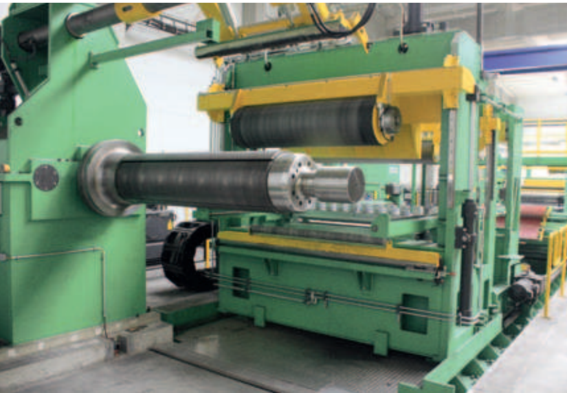
Aufwickelhaspel mit Andrückarm Recoiler with pressure arm
