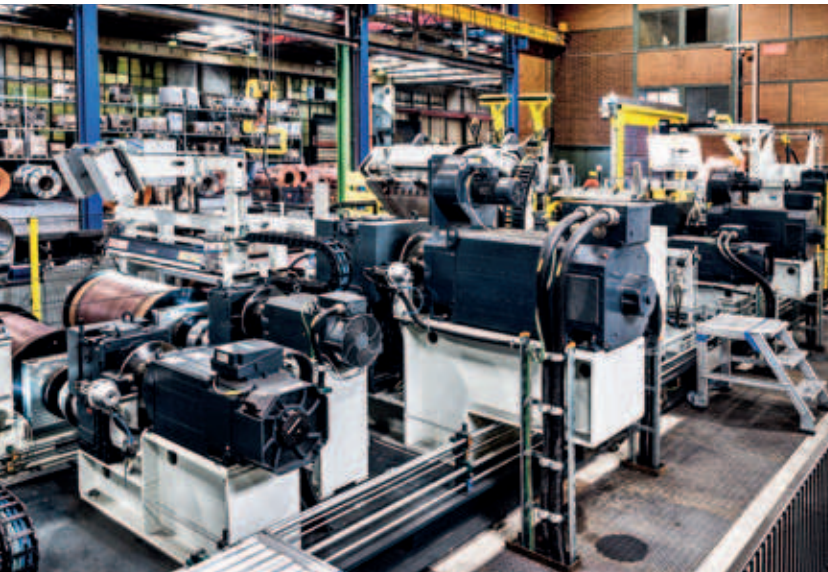
Einzelantriebe der S-Blöcke Single drive of the S-bridle rolls
