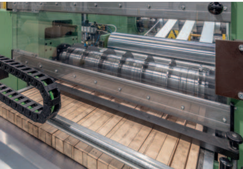
Schneiden mit Niederholz Slitting with wooden fingers
