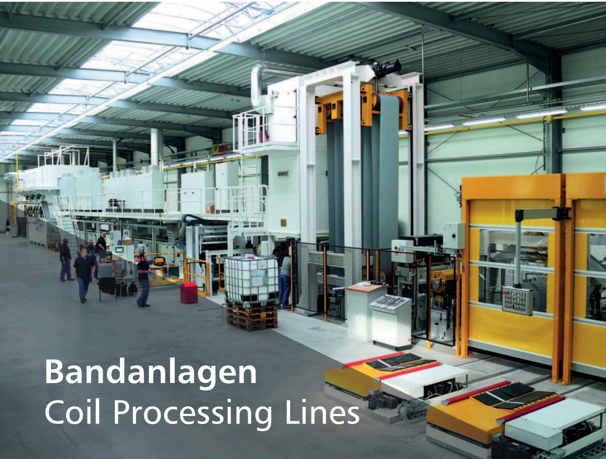
Bandanlage – Einlauf mit 2 Abwickler, Bundhubwagen und Heftmaschine Coil Processing Line – Entry with 2 Decoilers, Coil Car and Stitcher
