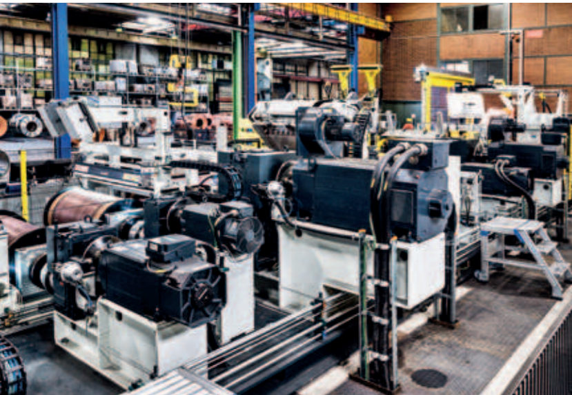
Einzelantriebe der S-Blöcke S-Type Bridle rolls with Single Drive
