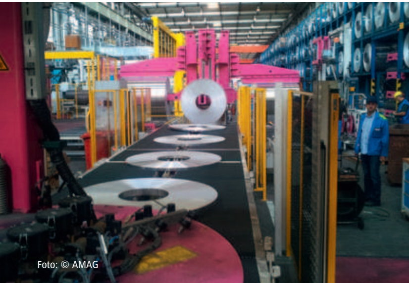
Automatische Verpackungsanlage für Aluminium-Coils Automatic Packaging Lines for Aluminum Coils
