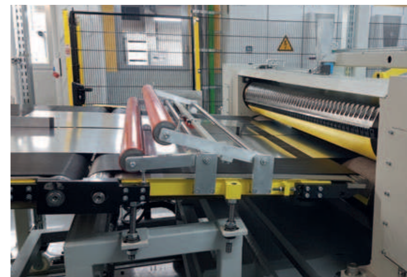
Trommelschere für die Platinen Drum Rotary Shear for Cutting Sheets
