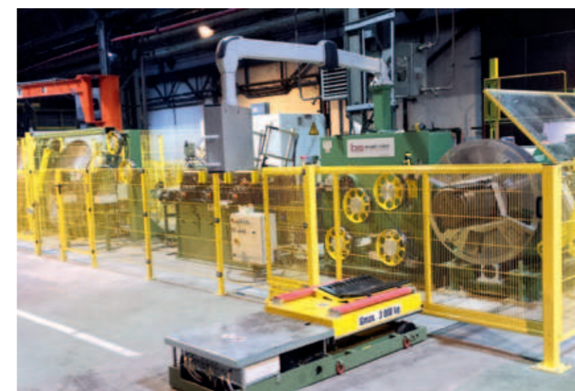
Verlegespuler mit Doppelabwickler Traverse Winder with Double Payoff Reel
