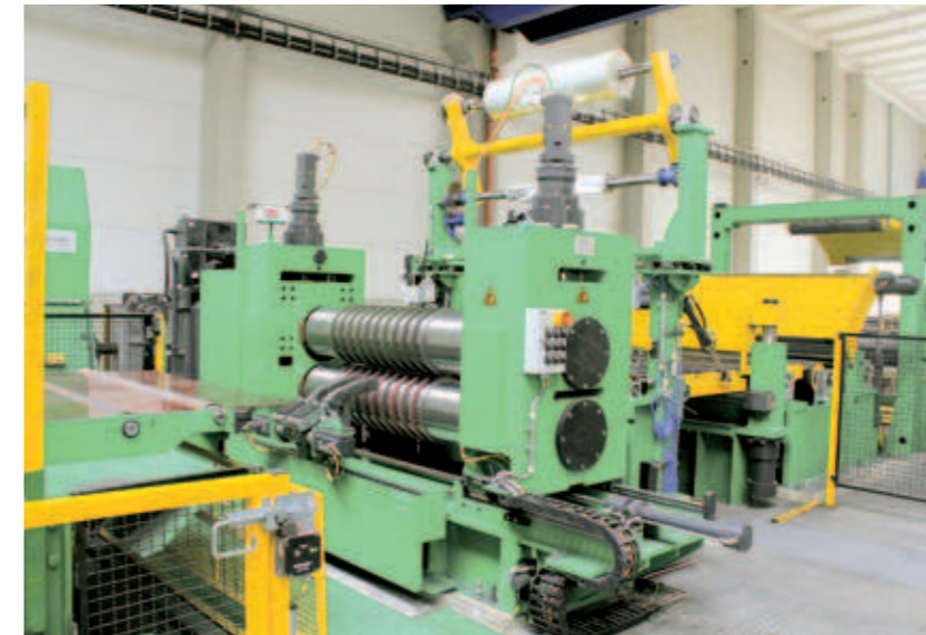
Präzisions-Längsteilschere Twin-CNC- Ausführung High Precision Slitting Head with Twin-CNC Knife Positioning Unit
