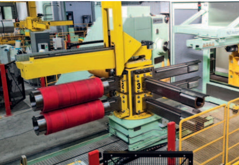
Automatischer vierarmiger Werkzeugwechsler mit Abschiebeschild und Werkzeugroboter Automatic Four-Arm Tooling Capstan with Push-Off Plate and Tooling Robot
