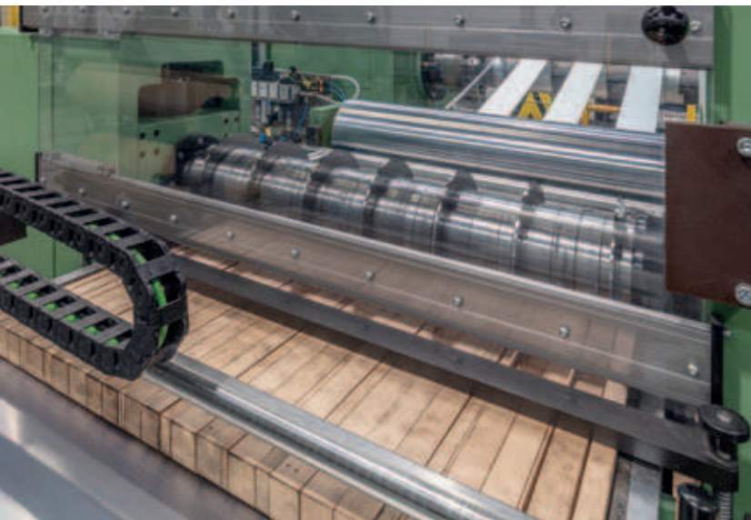
Schneiden mit Niederholz Slitting with Wodden Stripper Fingers
