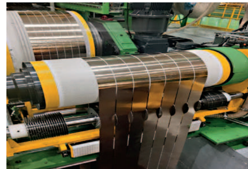
Schlingendoppler als Vakuumrolle mit automatischer Separierwelle für oberflächenempfindliche Materialien Loop Doubler using a Vacuum Roll with Automatic Separator Ring's Setup for Critical-Surface Materials
