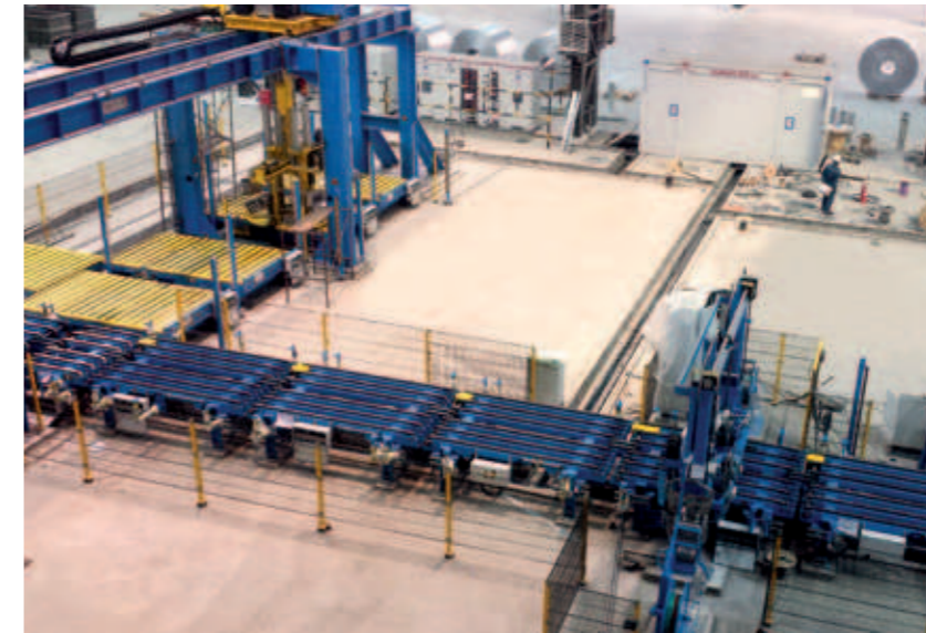
Vollautomatische Verpackungsanlage für Aluminium-Coils Fully Automated Packaging Line for Aluminum Coils
