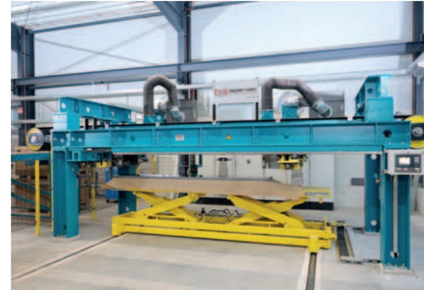
Vakuumstapler mit ausfahrbaren Stapelsentisch Vacuum Stacker with Traversing Stacking Table
