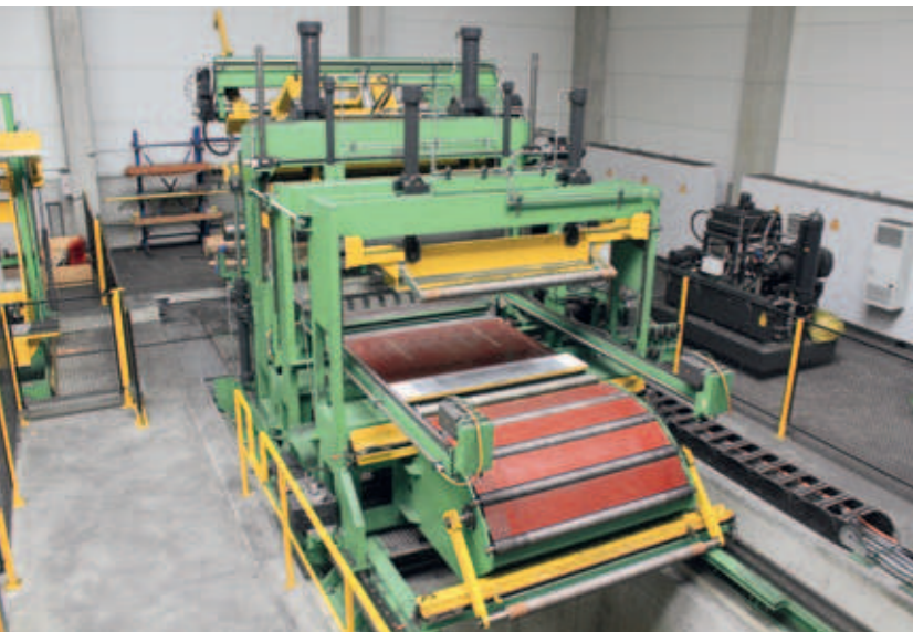
Fahrbares Bremsgerüst mit Streifeneinführvorrichtung Movable Brake Unit with Strip Feeding Device
