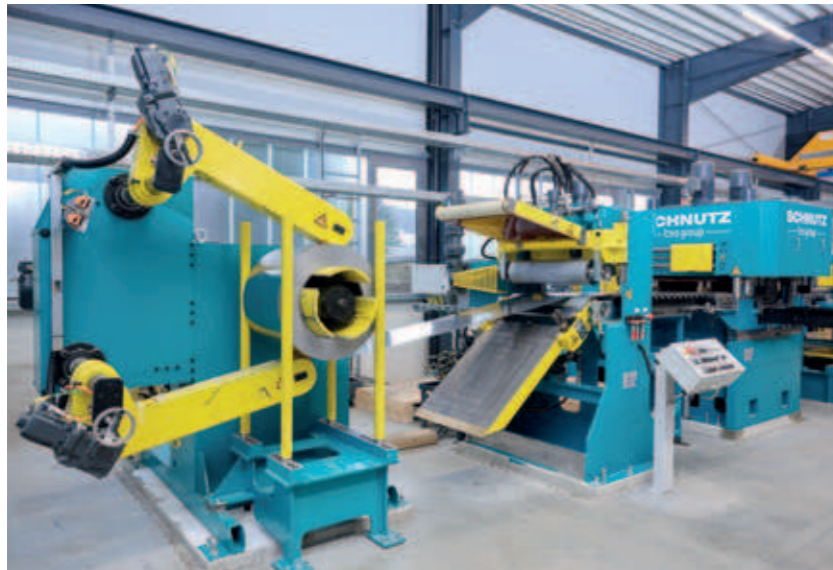
Einzugstreiber mit Abwickler Entry Pinch Roll Unit with Payoff Reel
