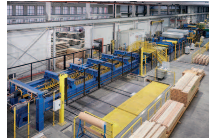
Einlauf in den Schwingarmstapler Entry of Swing Arm Stacker
