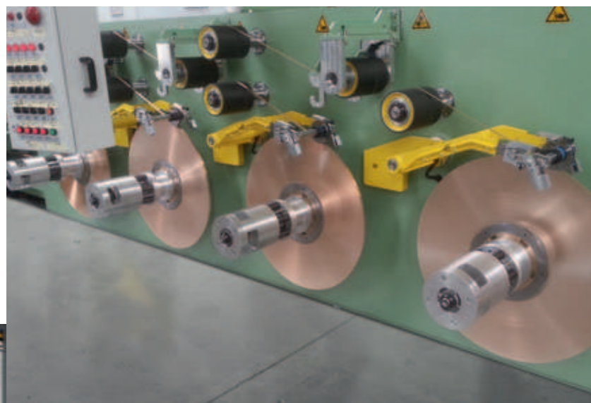
Aufwickeln mit Friktion und Separiereinheit Recoiling with Friction and Separator Device
