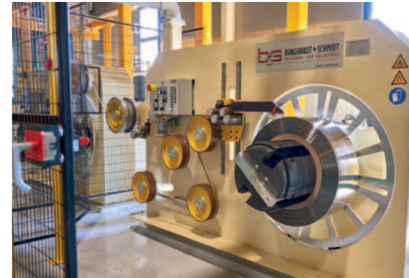
Verlegeaufwickler mit Tänzerinheit und Verlegefinger Traverse Winder with Dancer Arm and Strip Guiding Finger
