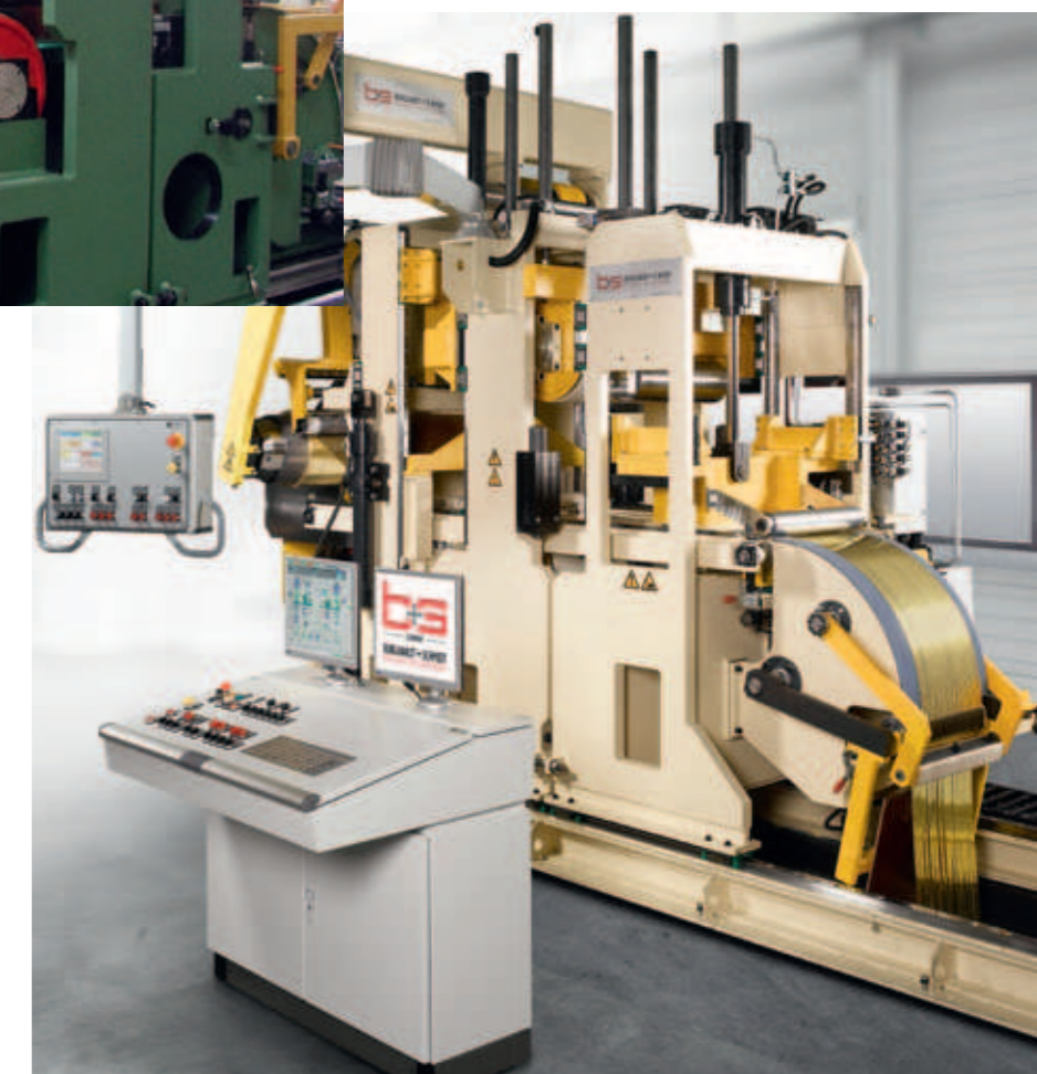
Fahrbares Bremsgerüst mit Plattenbremse, Treibrollen, Schopfschere und Streifeneinführvorrichtung Traveling Brake Unit with Tension Pad, Pinch Roll, Cropping Shear and Feeding Device
