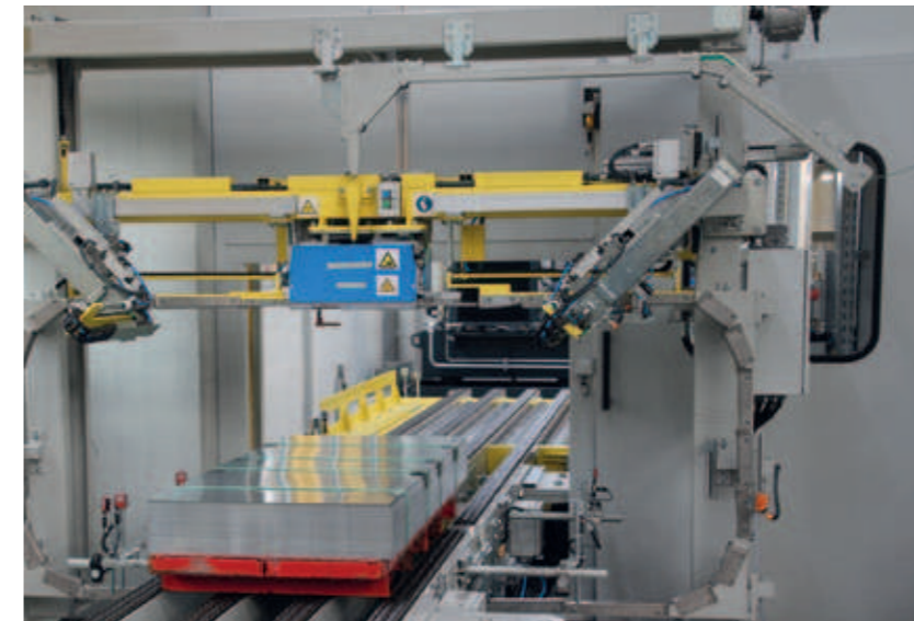
Automatische Abbindemaschine für das gestapelte Packet Automatic Banding Machine for the Stacked Material
