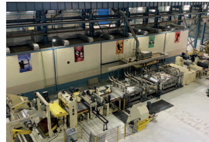
Umwickelanlage mit Bandschleifmaschinen | Recoiling Line with Belt Grinding Machines
