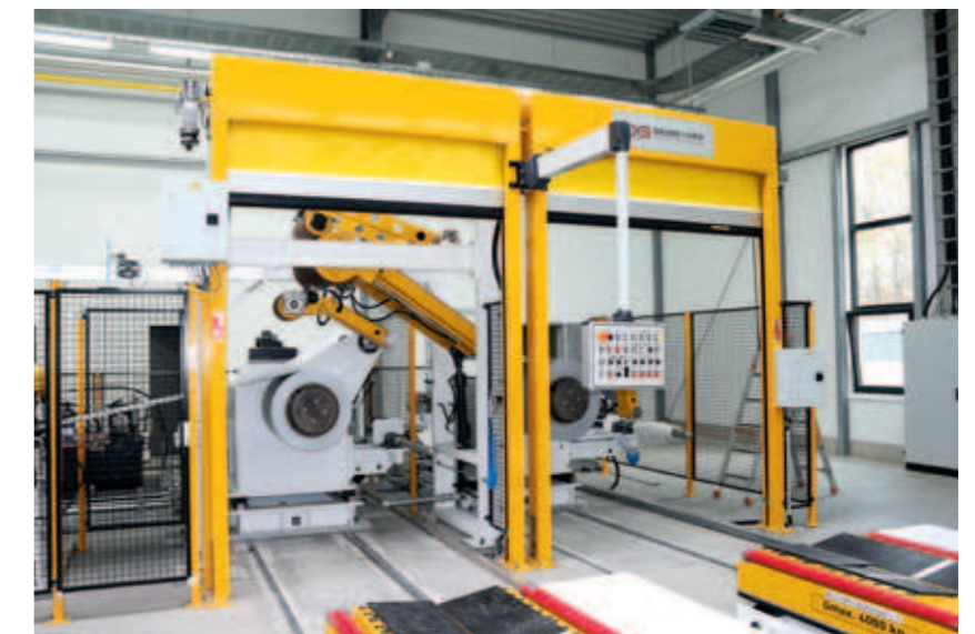
Bandanlage – Einlauf mit 2 Abwickler, Bundhubwagen und Heftmaschine Coil Processing Line – Entry with 2 Decoilers, Coil Car and Stitcher
