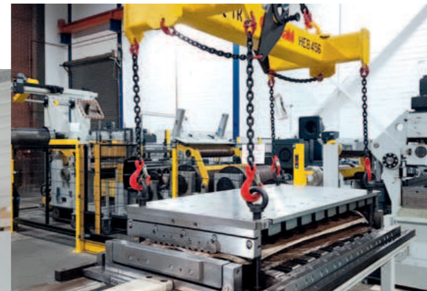
Richtkassettenwechsel Removable Cassettes
