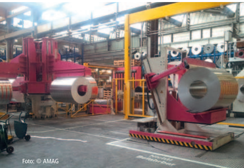
Drehkreuz 4-armig mit Andrückvorrichtung 4-Arm Turnstile with Hold-Down Arm
