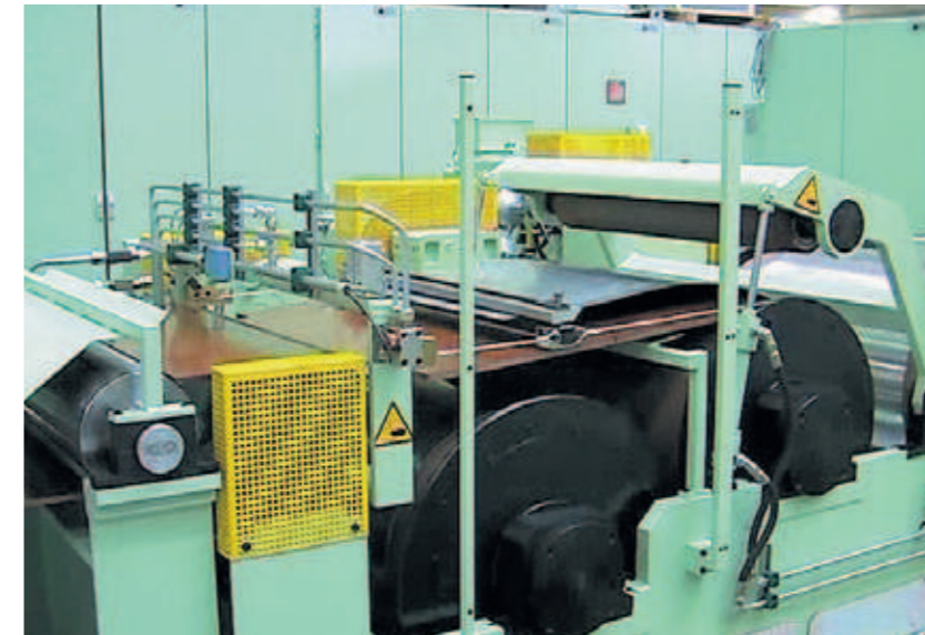
Vollautomatische Einfädelvorrichtung Fully Automatic Threading Device
