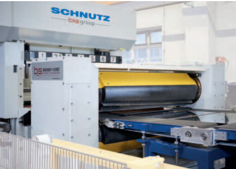
Schnutz Richtmaschine und Trommelschere mit automatischer Schnitthluftverstellung Schnutz Leveling Machine and a Drum Rotary Shear with Automatic Gap Adjustment
