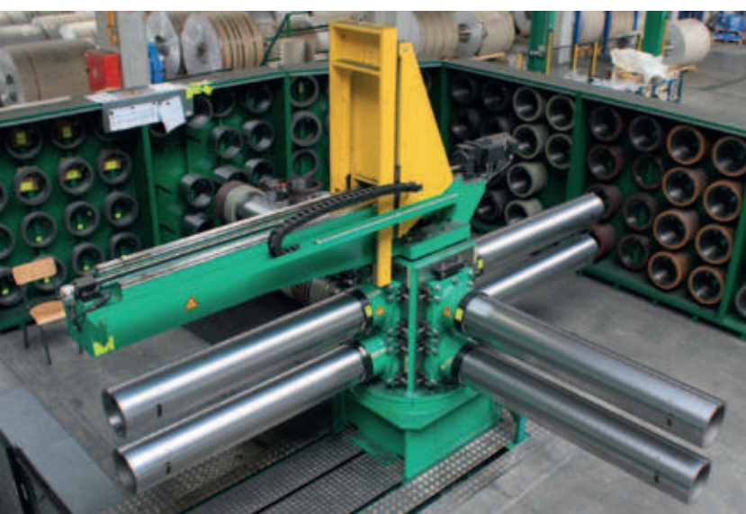
Vierarmiger Automatischer Werkzeugwechsler mit Abschiebeschild Four-Arm Tooling Capstan with Push-Off Plate
