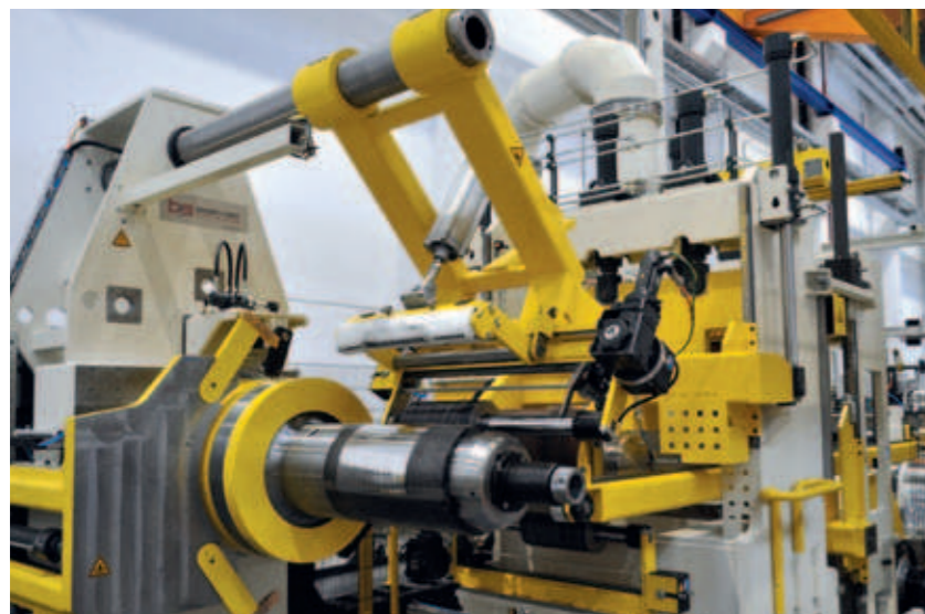
Vollautomatische Separierwelle und Haspelkopfklemmung Fully Automated Separator Rings and Mandrel Clamping
