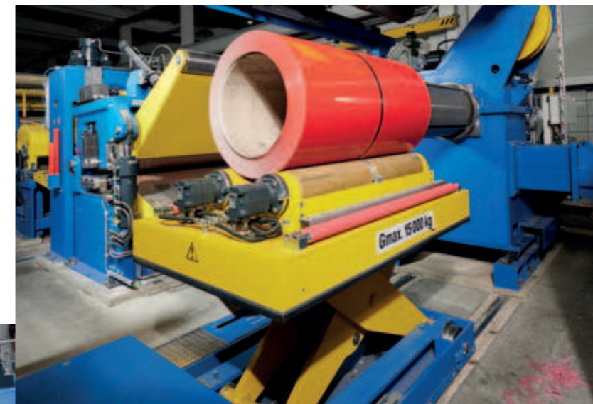
Bundhubwagen mit angetriebenen Tragrollen und integrierter Waage Coil Car with Support Rolls and Integrated Scale
