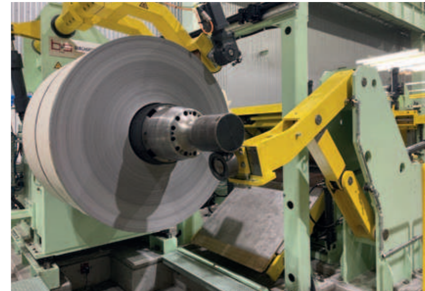
Abwickler und Dornabstützung Payoff Reel with Outboard Bearing Support
