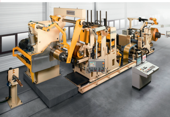
Längsteilanlage für Kupferband
